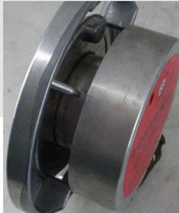
Abb. 19 Ventilationsdeckel aus Edelstahl
