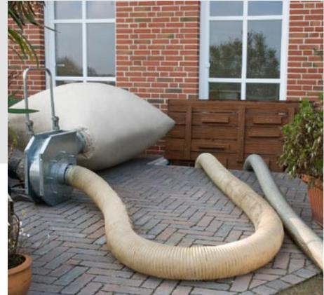
Abb. 20 Absaugventilator
