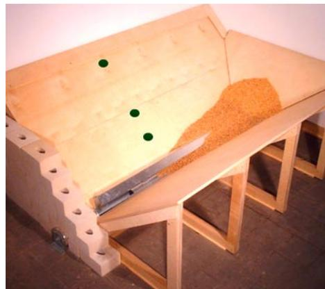
Abb. 26 Drucksensoren zur Füllstandsmessung im Schrägbodenlager
