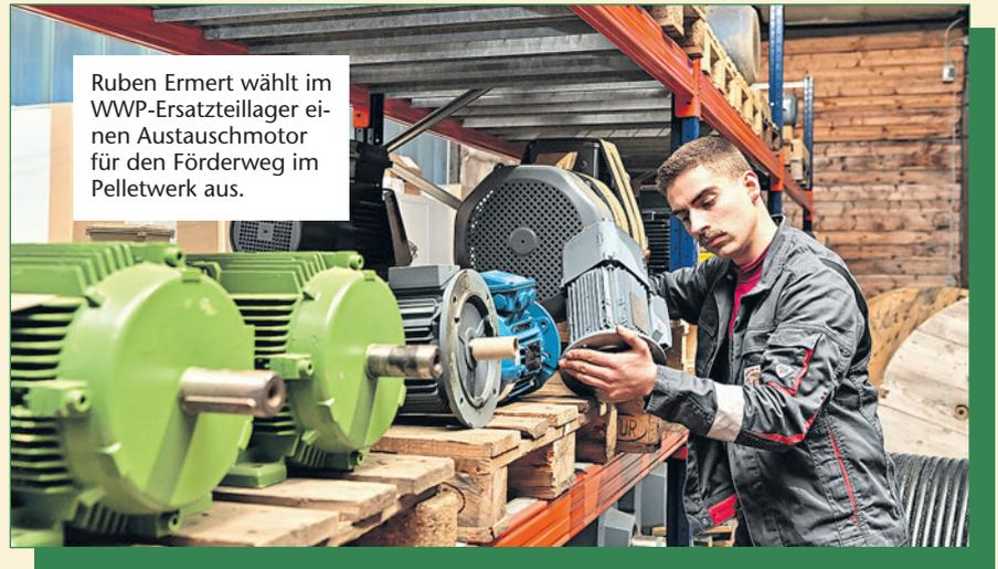
Ruben Ermert wählt im WWP-Ersatzteillager einen Austauschmotor für den Förderweg im Pelletwerk aus.
