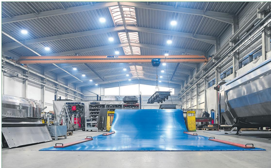
**Material:** In einer der Hallen in Bad Marienberg wird eine riesige Rolle des Kunststoffs abgewickelt, mit dem man den Boden einer Mulde „rutschiger“ auskleiden kann.
