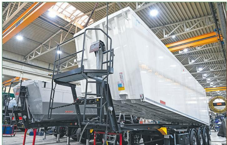
**Verbindung:** Hier wird eine Mulde auf das Fahrzeugstell montiert. Fotos: Schmalenbach
