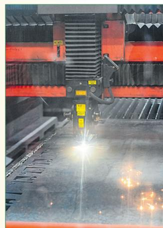
**Bearbeitung:** Der Laser schneidet benötigte Konturen aus dem Blech.
