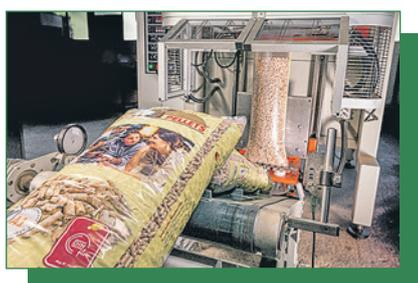
Auch als Sackware sind die „Westerwälder Holzpellets“ beliebt, 20 bis 25 Prozent der Jahresproduktion verlassen Langenbach in dieser Form. Selbst, wenn der „Absacker“ einmal stillstehen würde aufgrund einer Störung: eine Notreserve sichert auch dann den Nachschub für Pelletnutzer.
