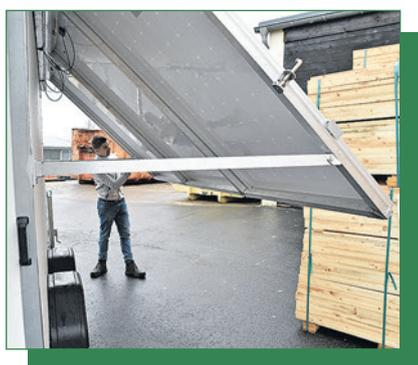
Ruben Ermert klappt eines der Solarpanels am „Mobilen Sonnenaggregat“ aus. Das ist ein als „Azubi-Projekt“ entstandener Anhänger, der Grünstrom nicht nur an jedem Ort produzieren, sondern auch speichern und wieder abgeben kann.
