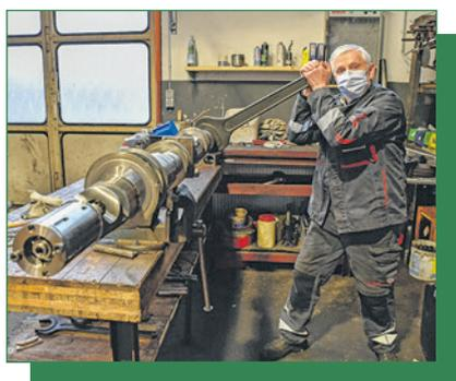
Manches Mal muss Willi Köhler mit einem „richtigen“ Schraubenschlüssel schaffen – etwa wenn es gilt, die Reglerwelle des Dampf-motors im Kraftwerk der „Westerwälder Holzpellets“ zu reparieren. Während der erfahrene Mitarbeiter in der Werkstatt arbeitet, lädt sein neues E-Auto vor der Halle – gratis und vom MANN-Lastmanagement kontrolliert.
