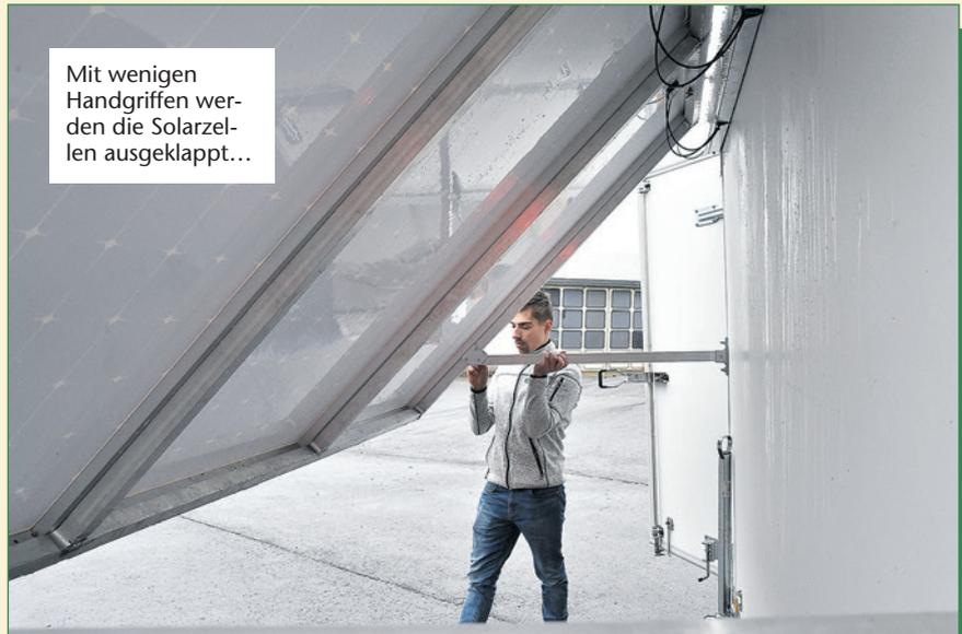
Mit wenigen Handgriffen werden die Solarzellen ausgeklappt...
