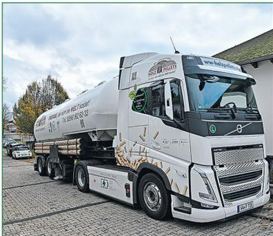
Betrachtet man die Effizienz des Antriebs, erscheint es widersinnig, Westerwälder Holzpellets noch mit Diesel-Lkw auszuliefern: Davon abgesehen, dass ein Dieselmotor klimaschädliche Abgase absondert, verbraucht er für 100 Kilometer etwa 585 Kilowattstunden (kWh), rechnet man den Energiegehalt des Kraftstoffs um. Die neuen E-Lkw der WWP benötigen nur 162. Aber wie alltagstauglich sind sie?
