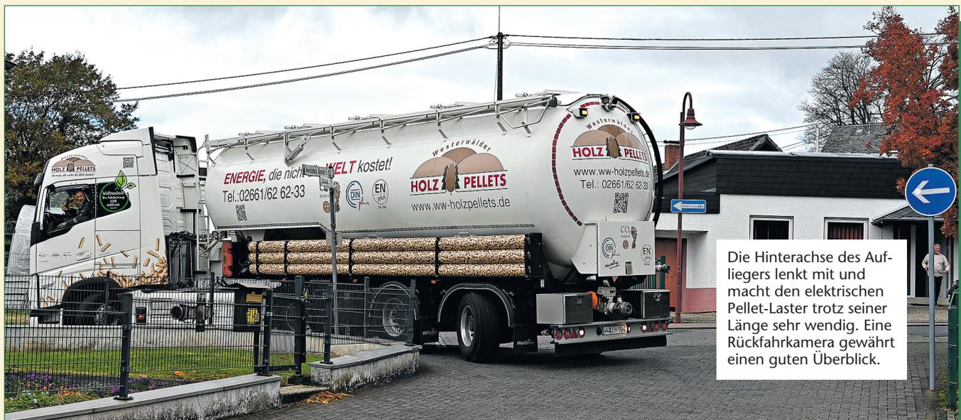
Die Hinterachse des Aufliegers lenkt mit und macht den elektrischen Pellet-Laster trotz seiner Länge sehr wendig. Eine Rückfahrkamera gewährt einen guten Überblick.
