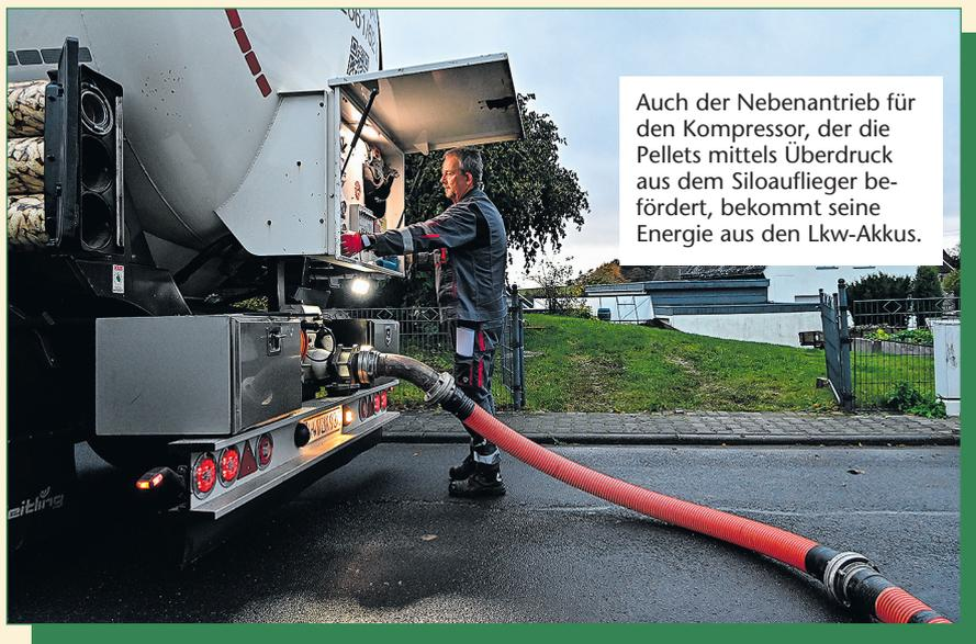
Auch der Nebenantrieb für den Kompressor, der die Pellets mittels Überdruck aus dem Siloaufleger befördert, bekommt seine Energie aus den Lkw-Akkus.
